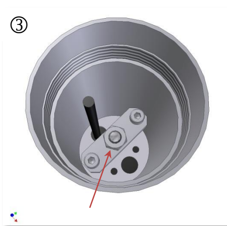
Remove the M6 nut using the wrench n.10
