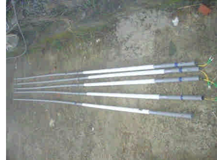
(b)現場封裝完成之 FBG 水壓計
